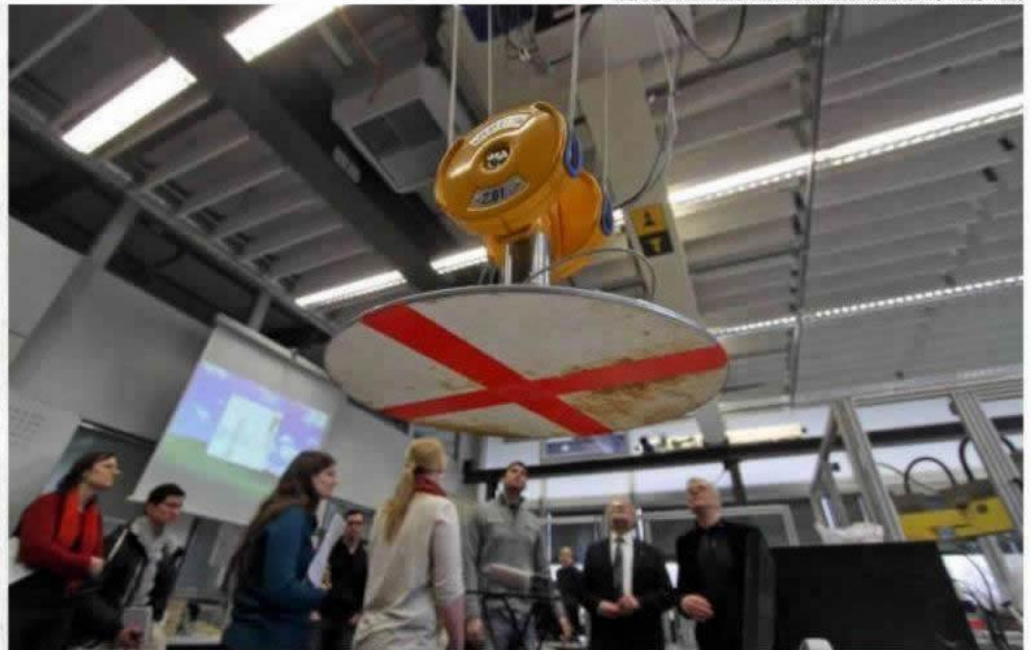
Laborleiter Prof. Dr. Wolfram Stanek (rechts) führte gestern zusammen mit Studenten vor, was der zum Roboter umgebaute Portaltraher so alles kann: Zum Beispiel mit einer unscheinbar wirkenden Magnethand ziemlich schwere Gewichte transportieren. 1)
